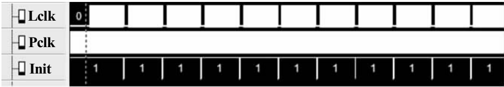
图 3 实测中断信号产生波形图 Fig. 3 Chart of the interrupt wave
